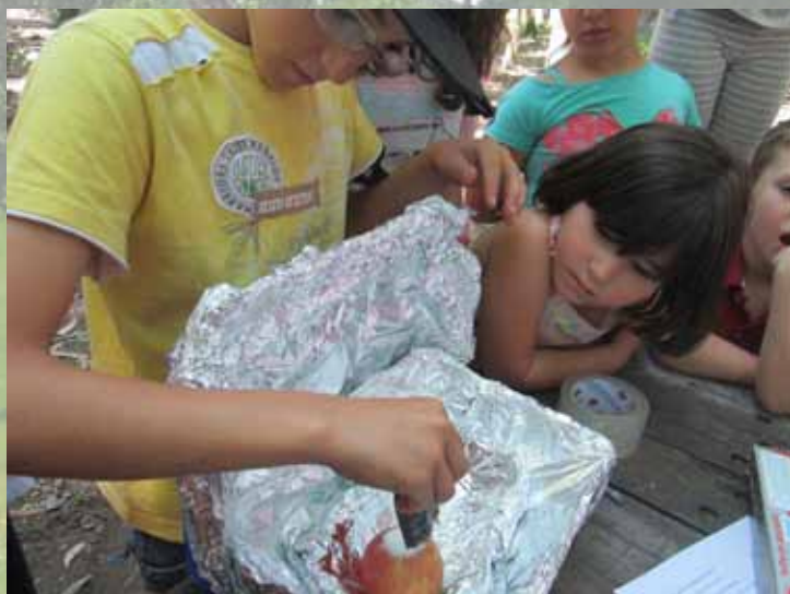
Prova 7: Construção de um forno solar, onde se colocou uma maçã com açúcar, um copo com água e um ovo. Colocou-se o forno ao sol, das 12h às 16h. Resultados - a maçã ficou assada e saborosa e o ovo cozido.
