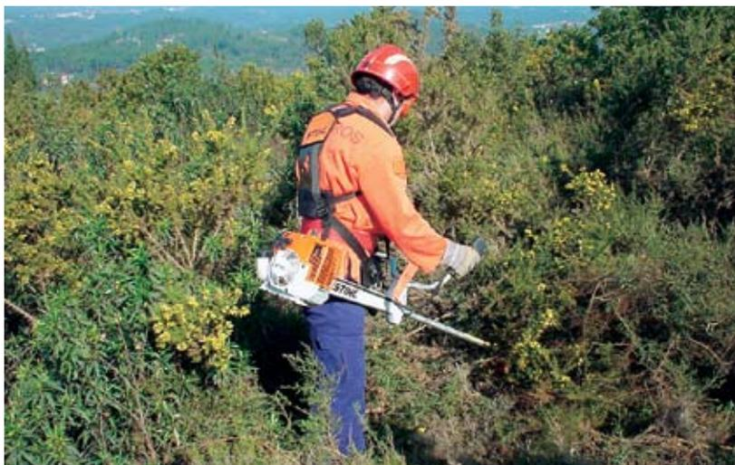
Fig. 50 Operação com motorroçadora de disco.
