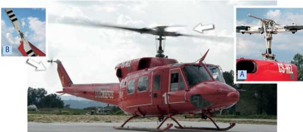
Fig. 107 Rotores de um helicóptero. A – rotor principal; B – rotor de cauda.
