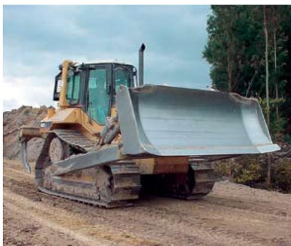
a) Máquina de rasto com lâmina
