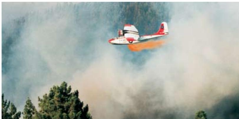
Fig. 76 Projecção de calda retardante.
