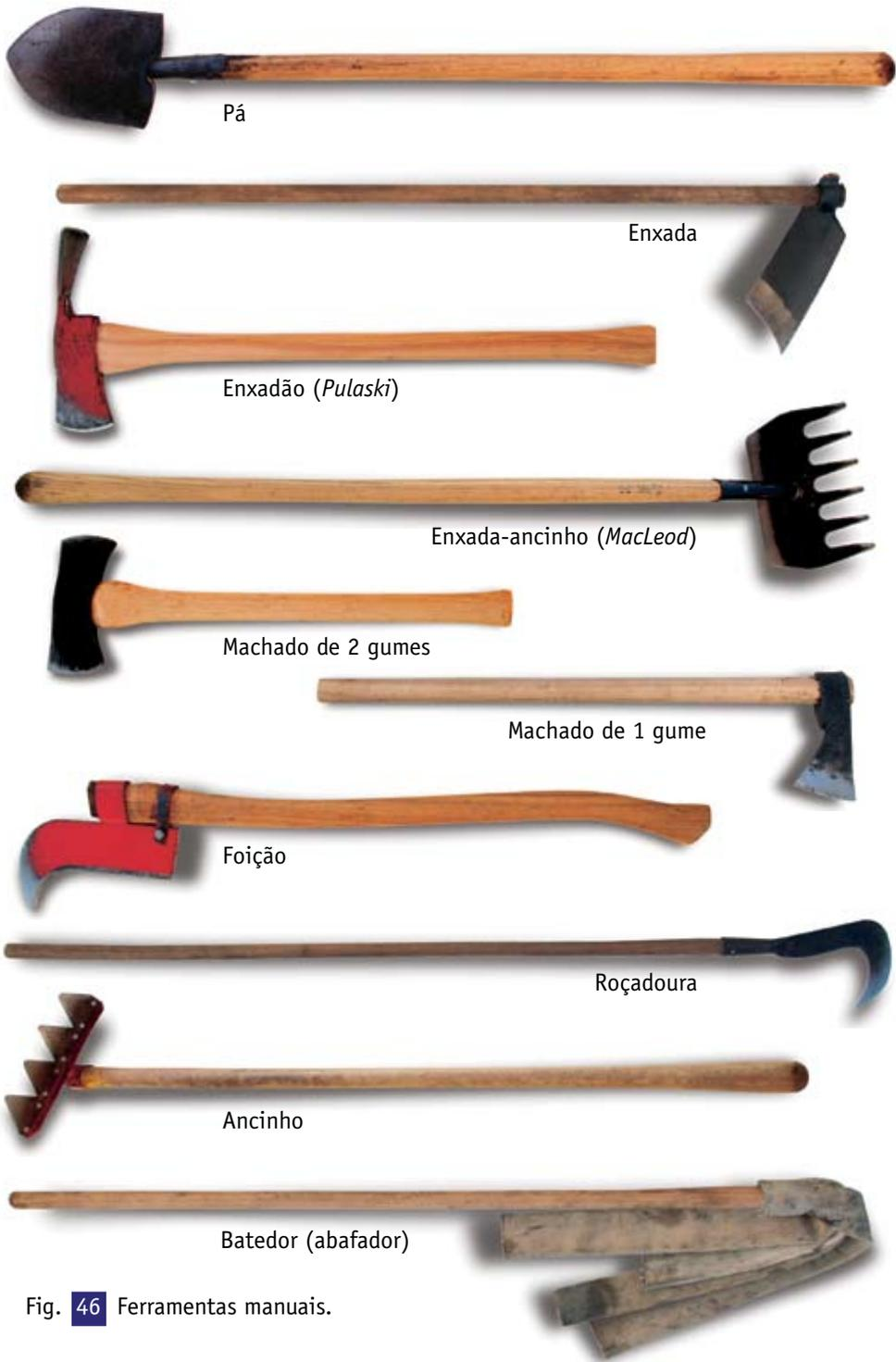
Fig. 46 Ferramentas manuais.
