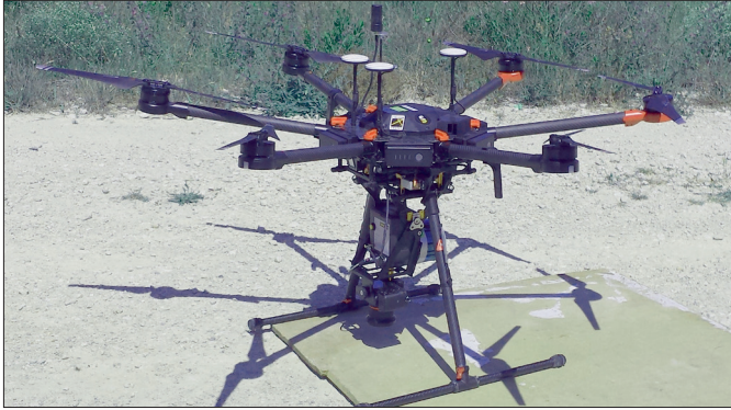
Fot. 31 - Drone avec capteur Lidar (Source: C. Bouillon).
